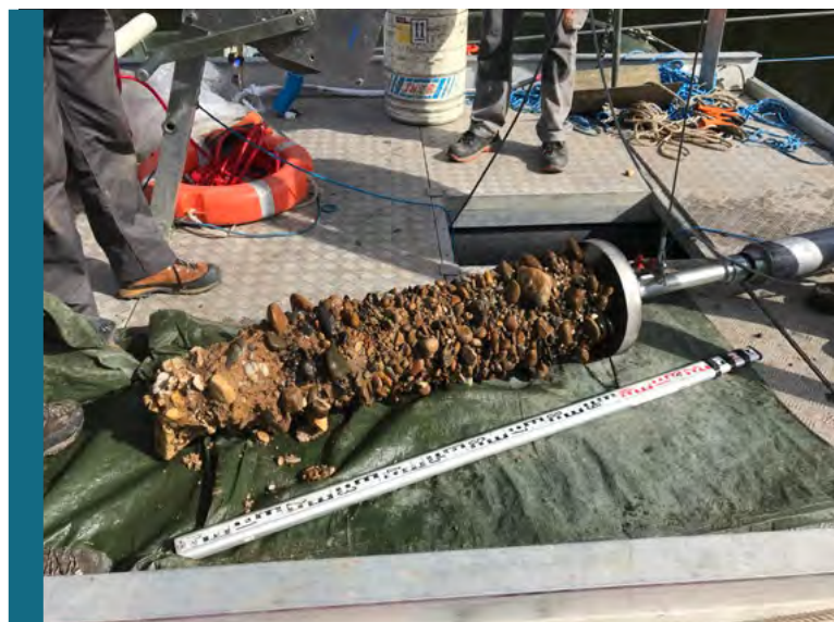
▲ [ci-dessus] Carotte issue de l'opération de cryocarottage réalisée dans la retenue du barrage de Mauzac © EPIDOR
